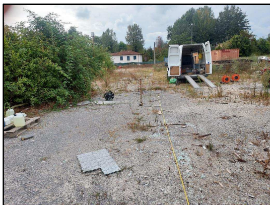
Stesa sismica MASW (vista da G24)
