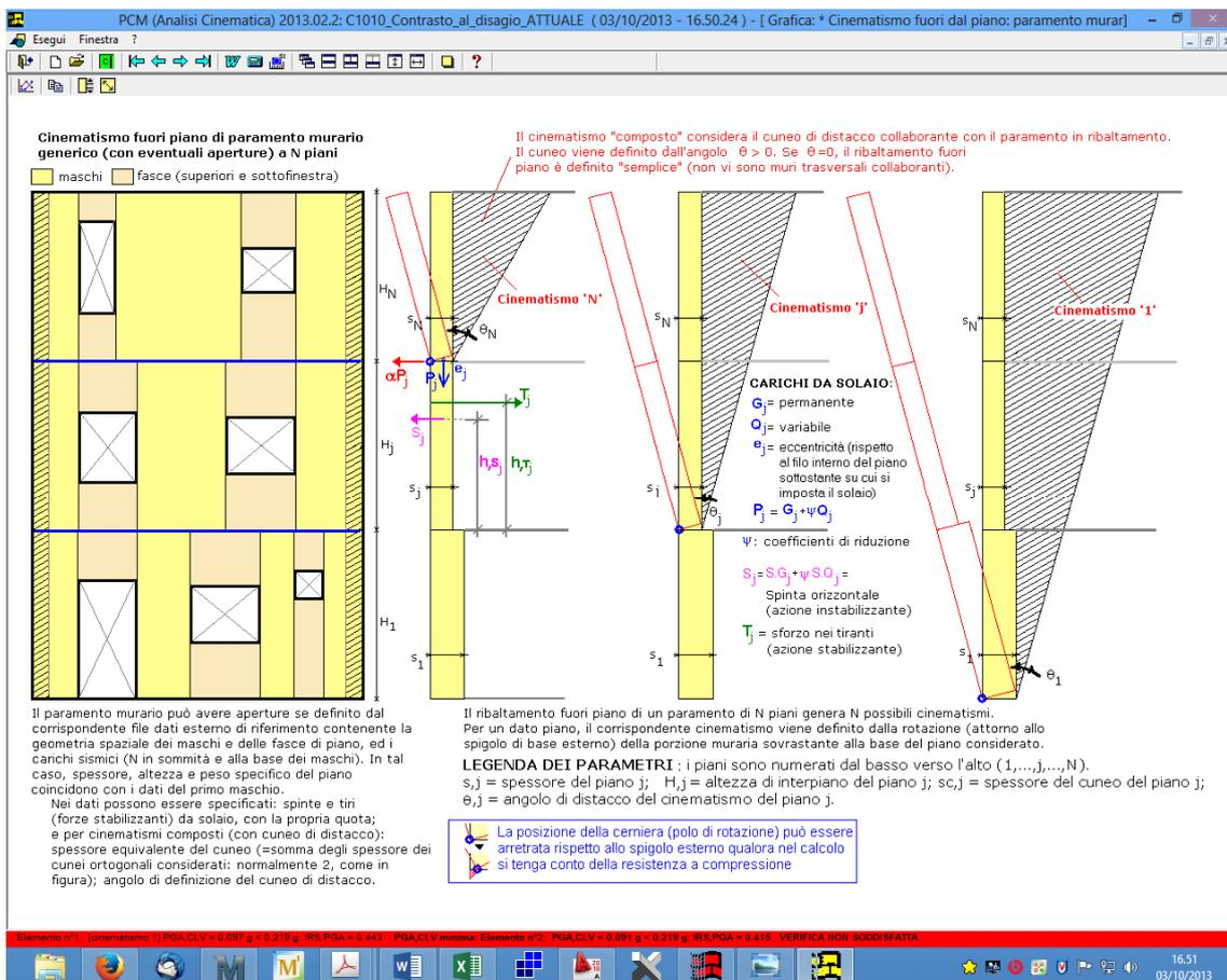
Figura 12- Meccanismo di rottura per ribaltamento
