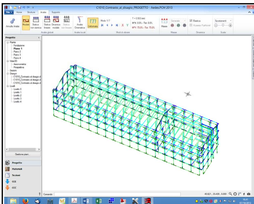
**Figura 7 – Modo di vibrare n.1- Principale in dir. trasversale**
