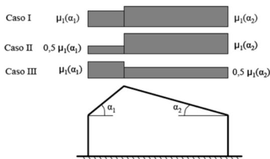
**Figura 4-** Condizioni di carico per coperture due falde
