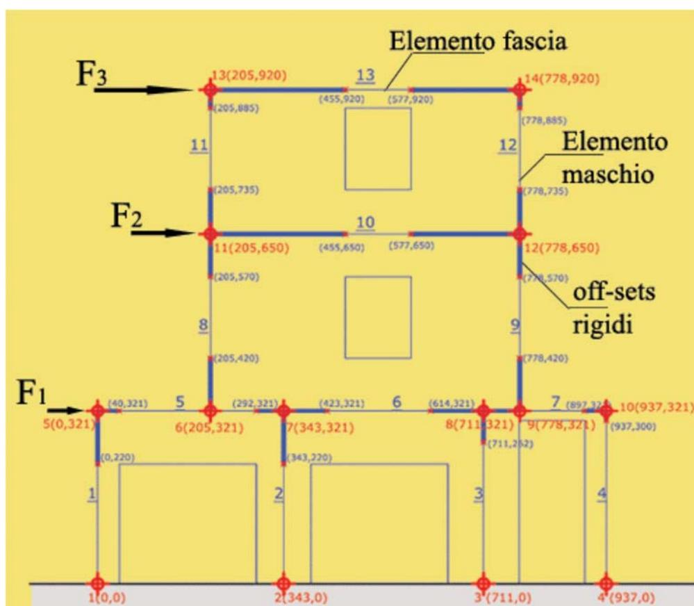
Nella definizione del modello, gli elementi strutturali considerati “secondari” (scale, ecc.) e gli elementi non strutturali autoportanti (tramezzi), essendo tali da non modificare significativamente il comportamento della struttura, sono stati rappresentati unicamente in termini di massa trascurando il loro contributo alla rigidità e alla resistenza del sistema strutturale.
