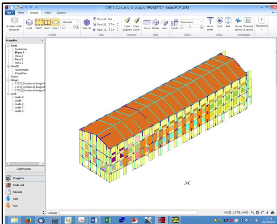
Fig. 15 – Modello P.C.M. 2013-Vista assonometrica del modello con distinzione cromatica degli elementi strutturali in base ai materiali (Vista Sud-Est)
