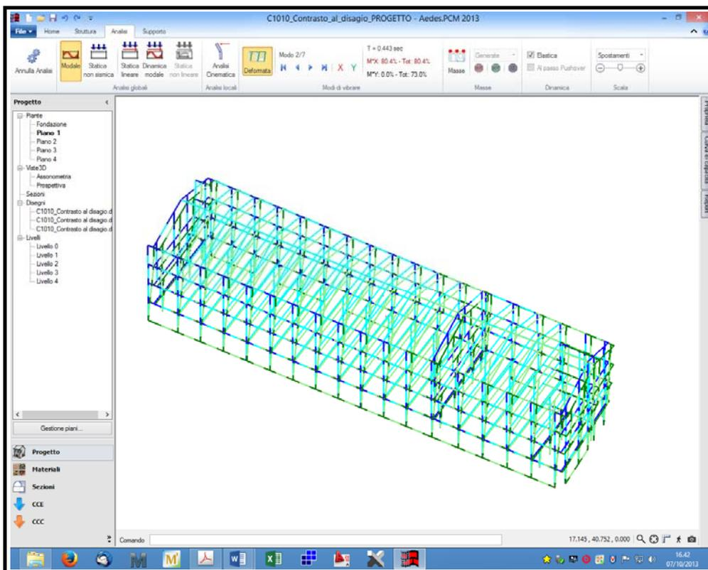
Figura 8 – Modo di vibrare n.2- Principale in dir. longitudinale
