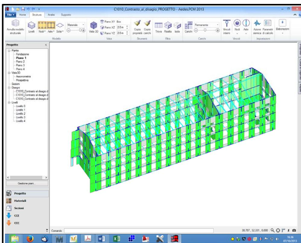
Figura 9– Verifica a presso flessione nel piano
