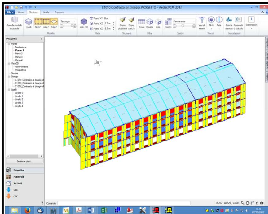
Fig. 13 – Modello P.C.M. 2013- Vista assonometria del modello con distinzione cromatica degli elementi strutturali in base alla tipologia
