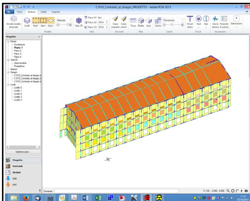
Fig. 14 – Modello P.C.M. 2013-Vista assonometrica del modello con distinzione cromatica degli elementi strutturali in base ai materiali (Vista Sud-Est)
