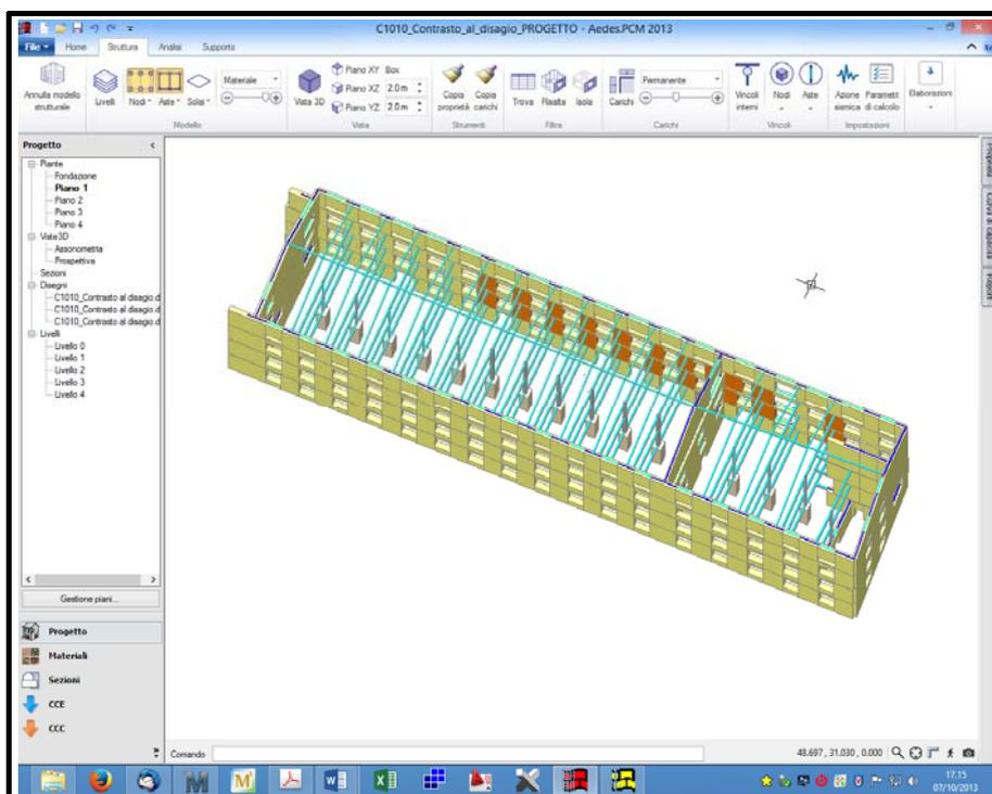
Fig. 16 – Modello P.C.M. 2013 -Vista assonometrica del modello con in evidenza le strutture portanti verticali
