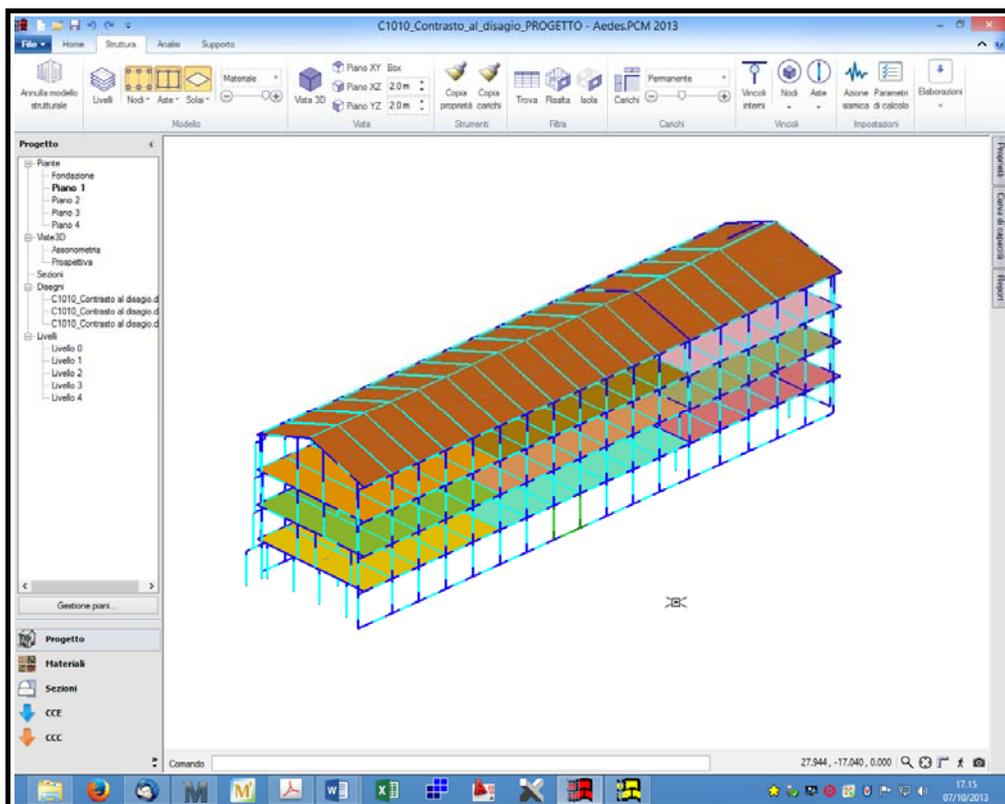
Fig. 17 – Modello P.C.M. 2013-Vista assonometrica del modello con in evidenza dei telai “equivalenti”
