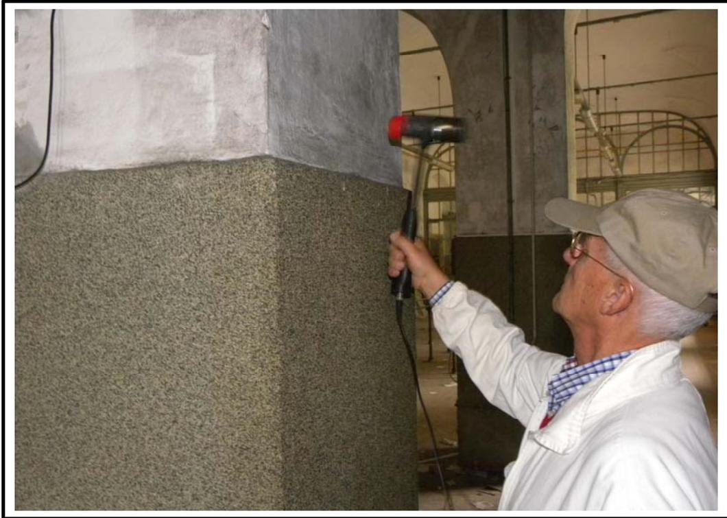
**Fig. 27 – Centro di competenza di tecnologie, arti e spettacolo: prova con le onde soniche - martello strumentato PCB 086D20.**
