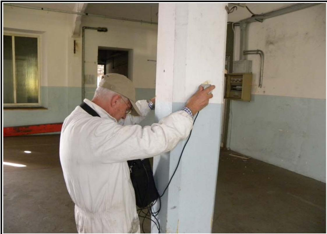
**Fig. 6 – Centro per attività di contrasto al disagio: prova ultrasonica su pilastro in c.a..**
