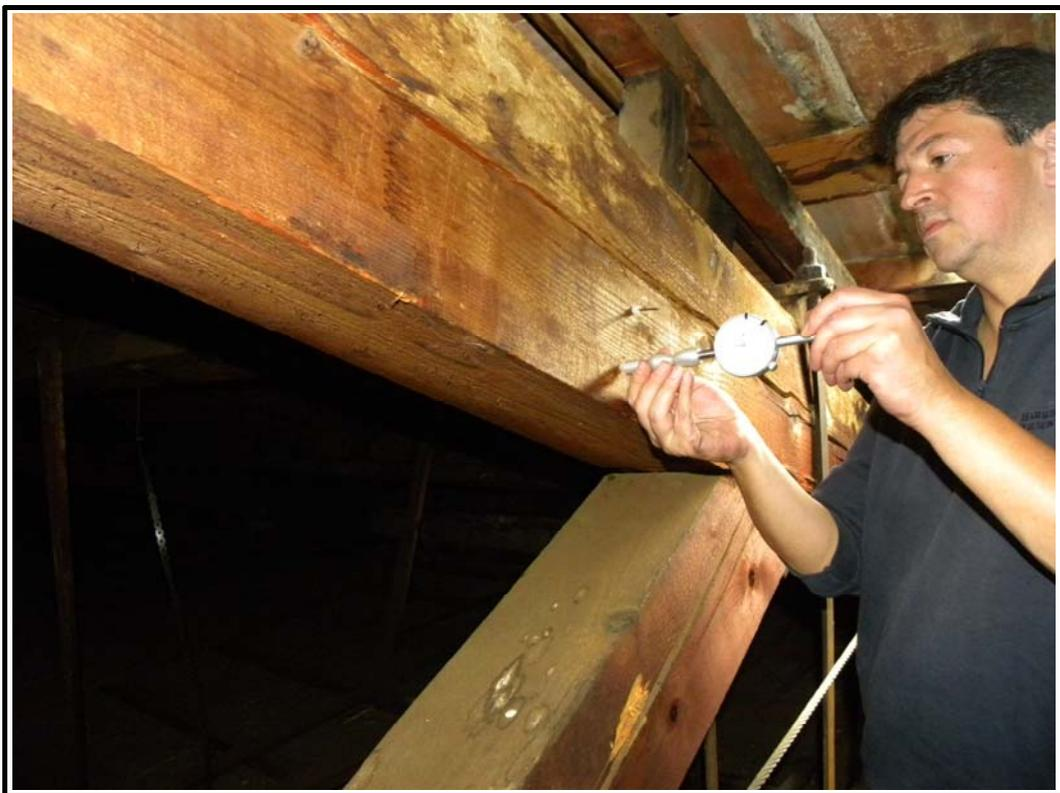
**Fig. 32 – Centro di competenza di tecnologie, arti e spettacolo: prova sclerometrica su elementi in legno delle capriate di copertura – misurazione della profondità di penetrazione dei chiodi.**
