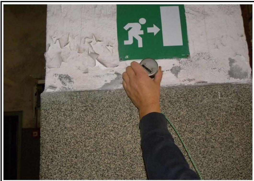
**Fig. 28 – Centro di competenza di tecnologie, arti e spettacolo: prova con le onde soniche – accelerometro PCB 393C.**
