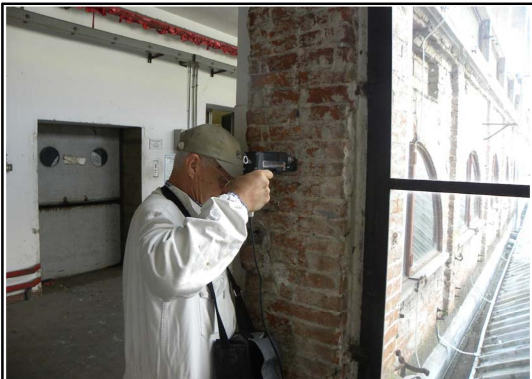
**Fig. 30 – Centro di competenza di tecnologie, arti e spettacolo: prova per determinare la resistenza a compressione delle malte.**
