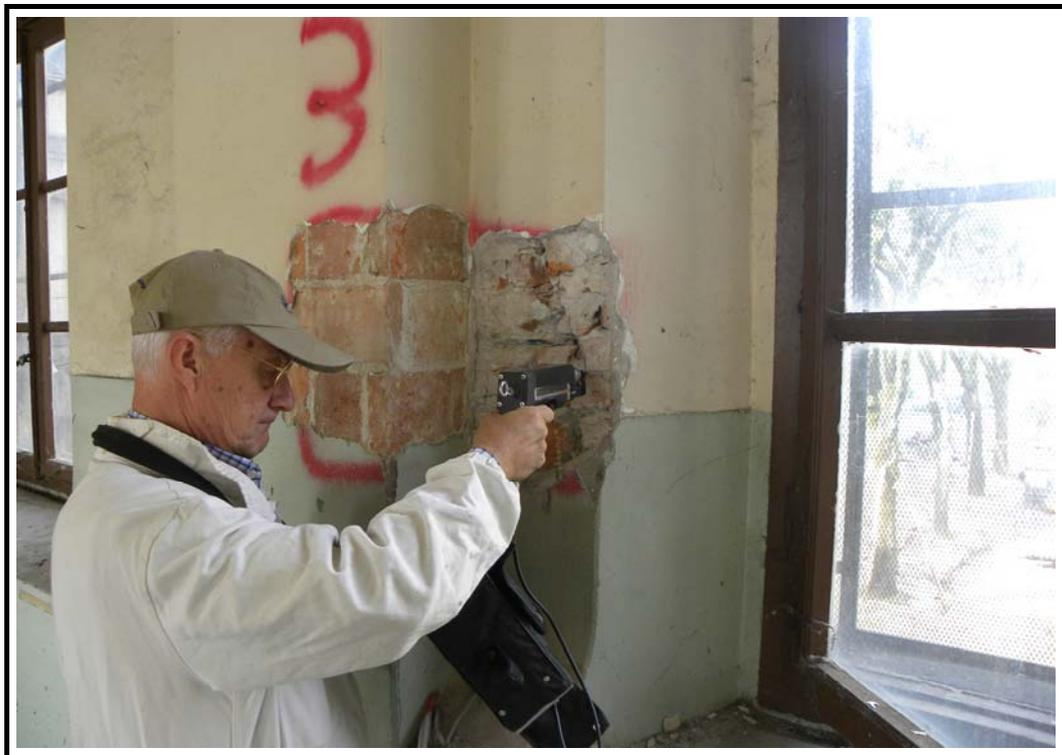
**Fig. 14 – Centro di competenza per lo sviluppo e l'insediamento d'impresa ad alta innovazione tecnologica: prova per determinare la resistenza a compressione delle malte.**
