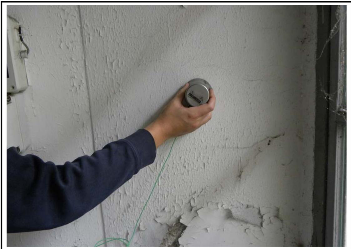
**Fig. 12 – Centro di competenza per lo sviluppo e l'insediamento d'impresa ad alta innovazione tecnologica: prova con le onde soniche – accelerometro PCB 393C.**
