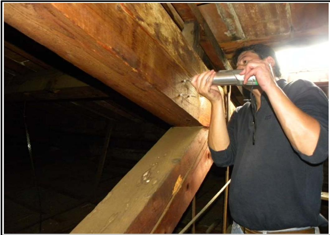
**Fig. 31 – Centro di competenza di tecnologie, arti e spettacolo: prova sclerometrica su elementi in legno delle capriate di copertura – esecuzione prova a mezzo di sclerometro Woodpecker.**
