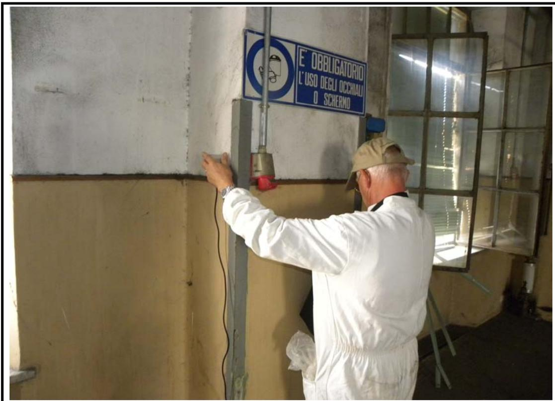
**Fig. 3 – Centro per attività di contrasto al disagio: Misura della velocità di propagazione delle onde ultrasoniche su pilastro in muratura.**
