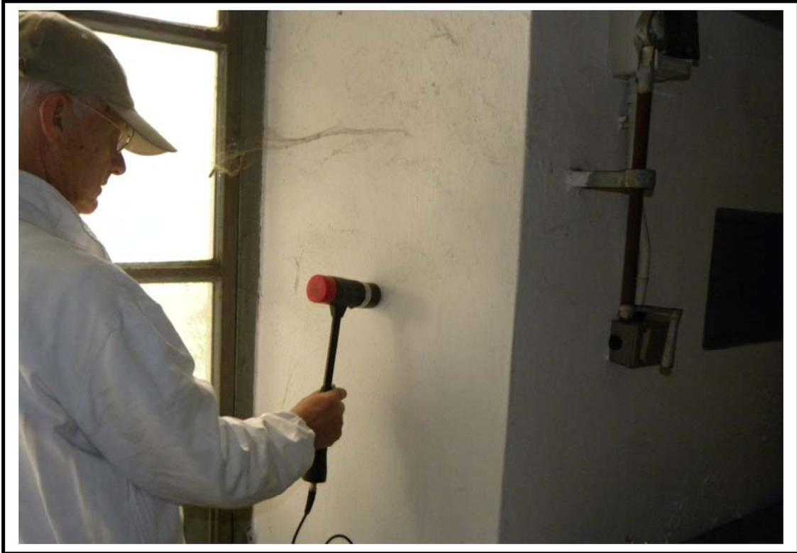
**Fig. 11 – Centro di competenza per lo sviluppo e l'insediamento d'impresa ad alta innovazione tecnologica: prova con le onde soniche - martello strumentato PCB 086D20.**
