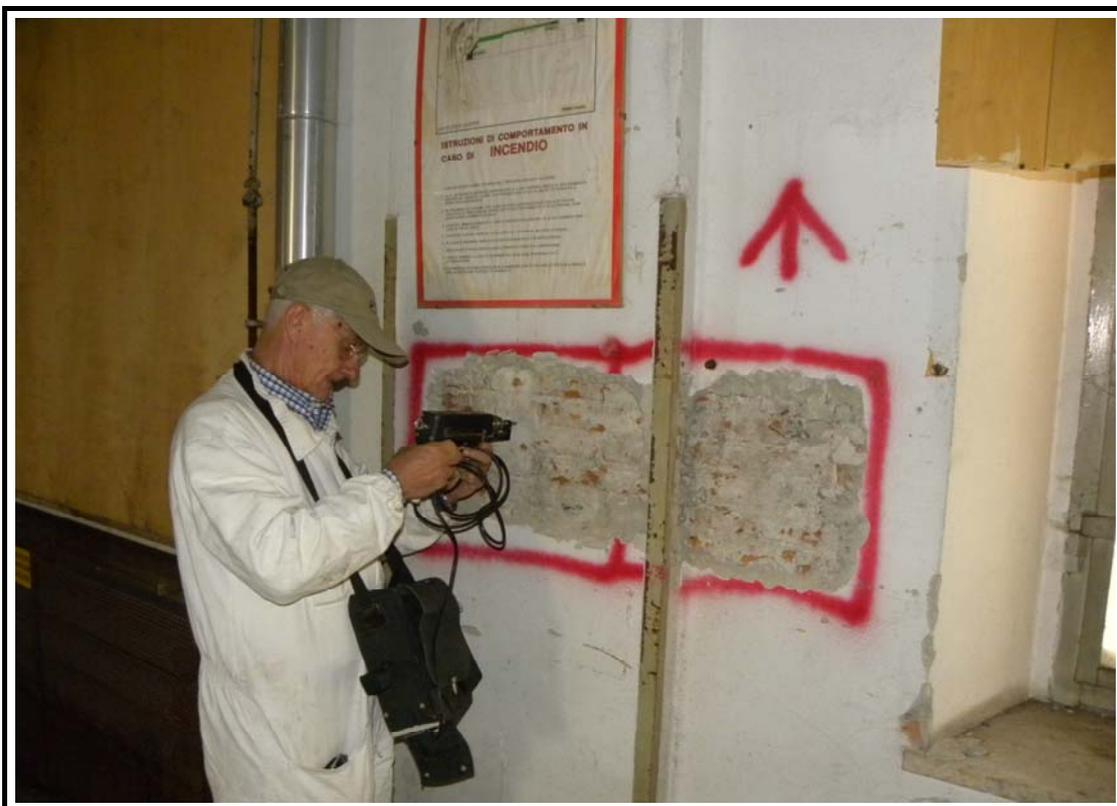
**Fig. 4 – Centro per attività di contrasto al disagio: Prova per determinare la resistenza a compressione delle malte nelle murature.**
