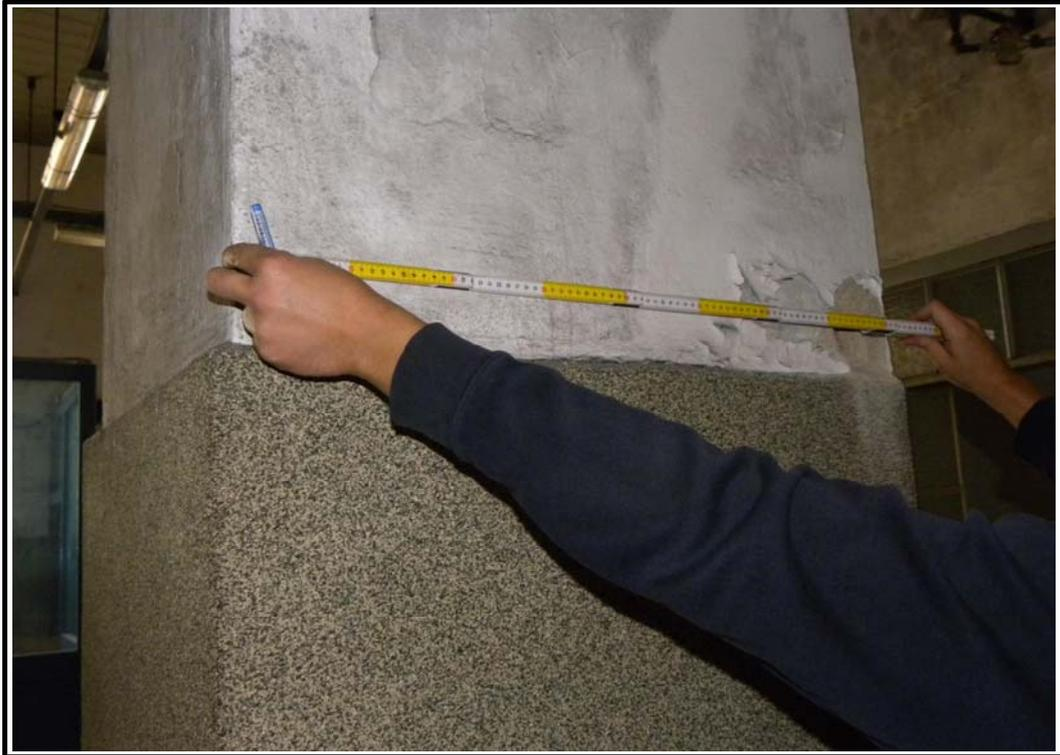
**Fig. 29 – Centro di competenza di tecnologie, arti e spettacolo: prova con le onde soniche – misurazione del percorso.**
