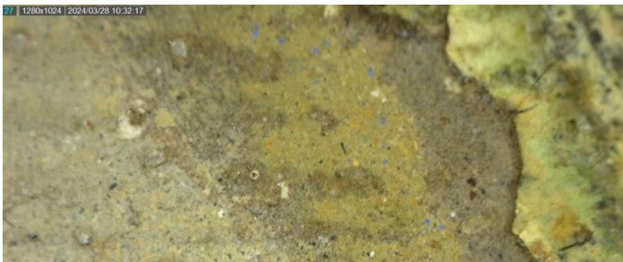
*Figura 37: Osservazione con microscopio da contatto a 200x. Indagine effettuata sulle superfici del palchetto 18. Si noti la presenza di diversi livelli stratificati che farebbero supporre o interventi successivi o ad una tecnica decorativa che prevedeva la messa in opera di diversi livelli preparatori.*
