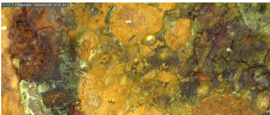
*Figura 38: Osservazione con microscopio da contatto a 200x. Indagine effettuata sulle superfici del palchetto 18 in corrispondenza delle aree decorate con fondo giallo e righe nere. Si noti la presenza di una sostanza resinosa in stato avanzato di invecchiamento. Potrebbe trattarsi della preparazione per la stesura dell'oro a conchiglia*
