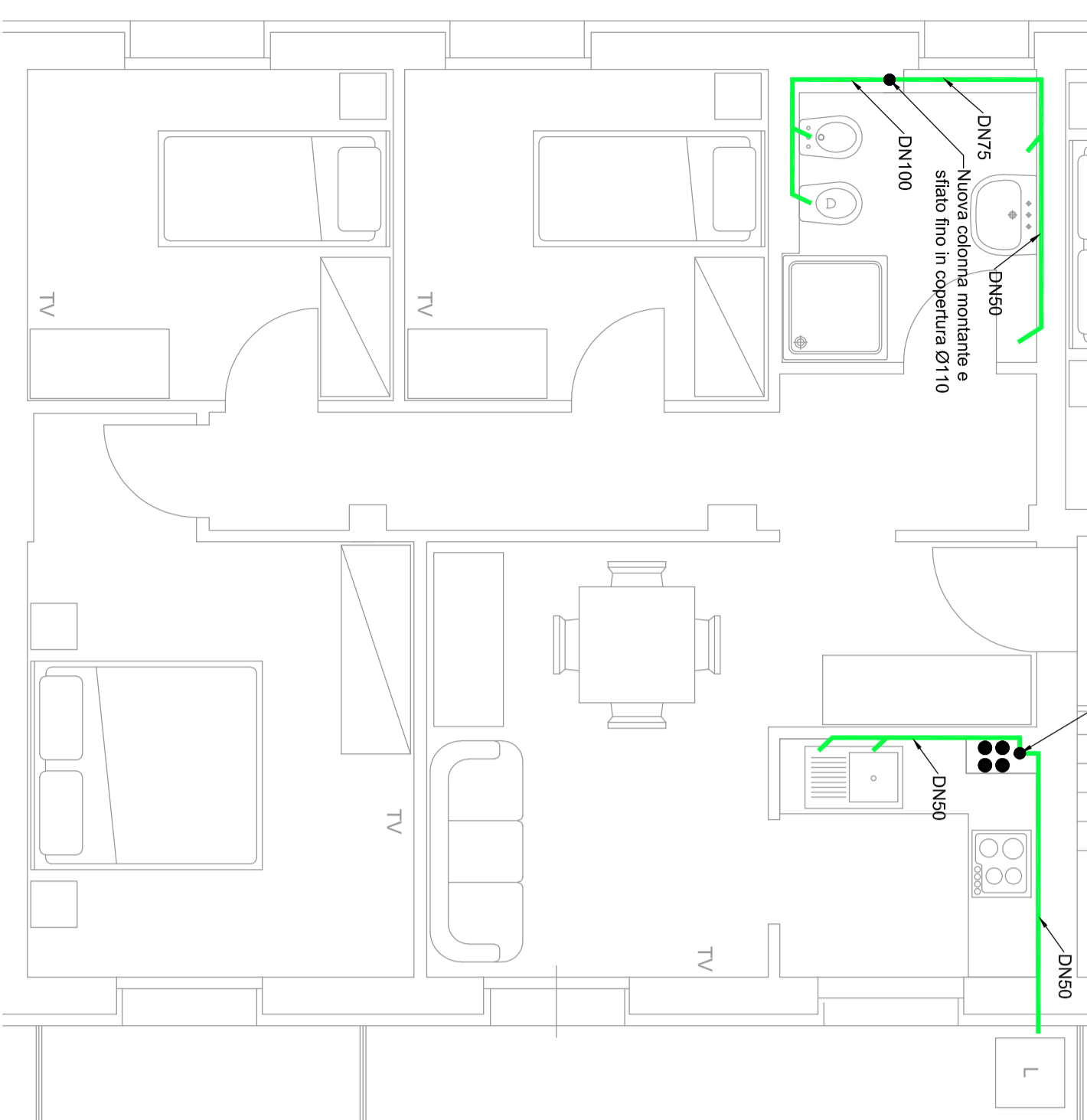
07 IMPIANTO IDRICOSANITARIO Scala 1:50 - APPARTAMENTO TIPO I
